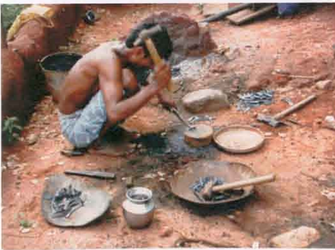
Bild 2 Alle Werkzeuge, Hämmer, Meißel, Holzkohle, Esse, Blasebalg, Schalen mit Halbzeug und mit fertigen Nägeln Wasserkrug zum Abschrecken und Härten
