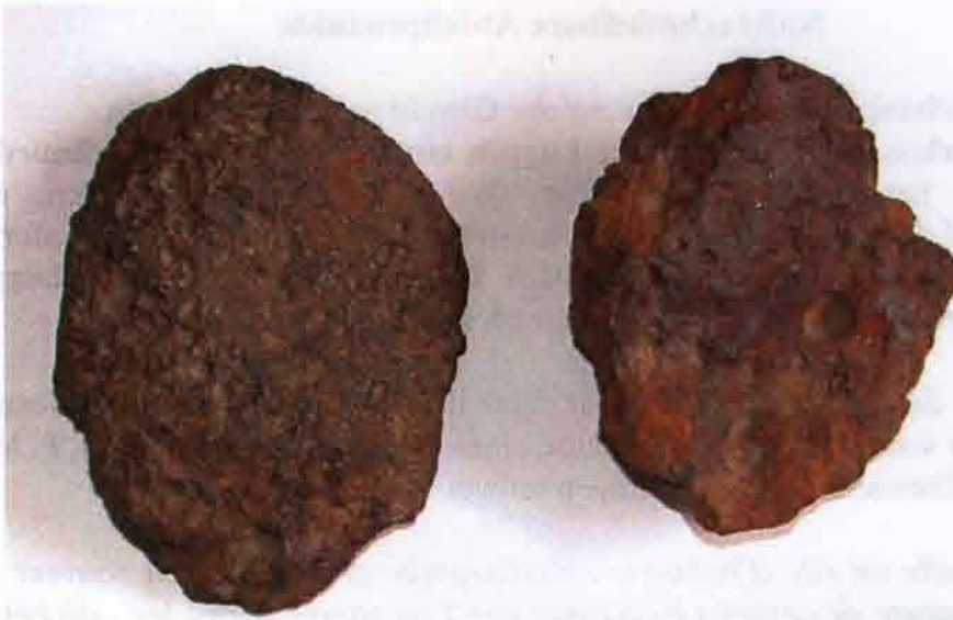
Schmiedeschlacken, Kalotschlacken so genannte „Ofensauen“
