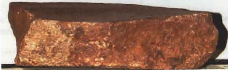
Seitenansicht der Platte auf welcher der tellerartige Ausschliff gut zu erkennen ist
