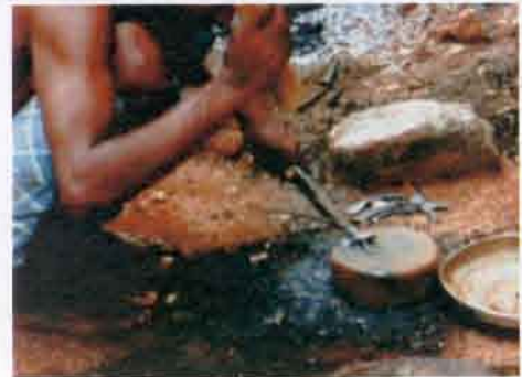
Detail : Block mit eingeschlagenem „Mini-Amboss“ zum Feinschmieden
